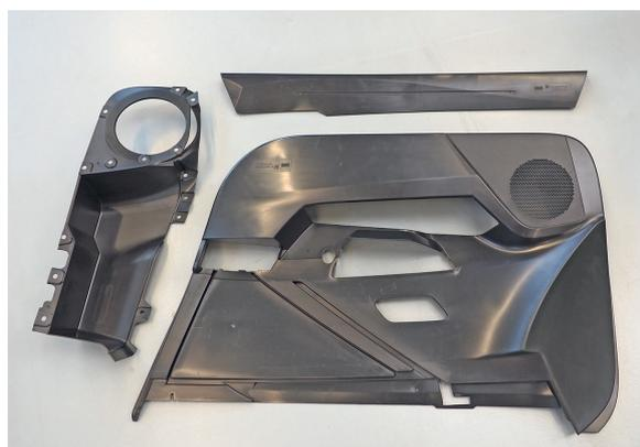
**In einem Schuss:** Das Versuchs- und Entwicklungswerkzeug fertigt eine komplette Baugruppe für die Türtafel © Hanser/Schröder
