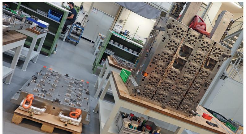
**Fallbeispiel Healthcare:** Eine Tampon-Einführhilfe (links), die mit einem Multi-Kavitäten-Werkzeug (rechts) gefertigt wird © Hanser/Schröder
